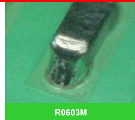
В связи с миниатюризацией компонентов, увеличивается отношение площади поверхности отпечатка паяльной пасты к объему, что зачастую приводит к неполному слиянию припоев пасты и выводов компонентов. Специально разработанный флюс обеспечивает полное смачивание выводов, предотвращая повторное окисление металла в процессе оплавления.
